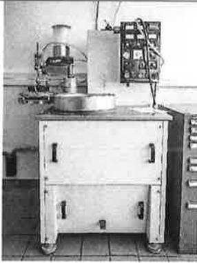
***Machine de polissage - SOMOS MDF 400 PR
